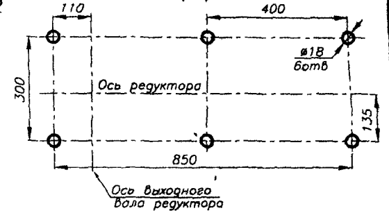
СХЕМА РАСПОЛОЖЕНИЯ БОЛТОВ КРЕПЛЕНИЯ ЭЛЕМЕНТОВ ПРИВОДА К РАМЕ (15)
